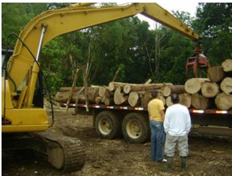
**Figura 13. Retroexcavadora adaptada como cargador de madera.**
