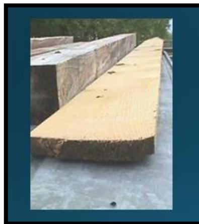
Figura 13. Bloques y tablas obtenidos del proceso de aserrío secundario.
