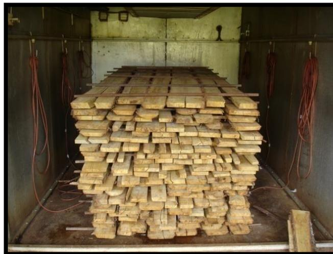
Figura 18. Secado convencional de madera.
