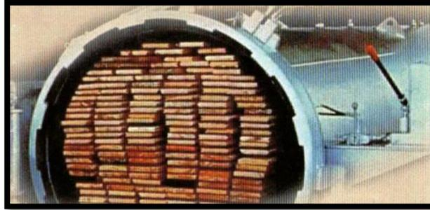
Figura 21. Tanque de acero donde se aplica el método de preservación vacío-presión.
