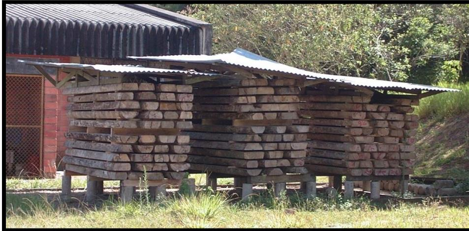
Figura 17. Pila de secado al aire.
