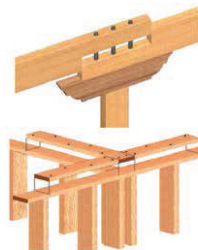
Fuente: www.teycubermaderas.com Figura 20. Uniones estructurales.
